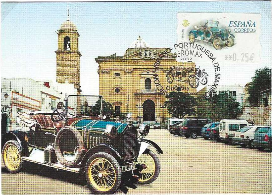
Humber "T" , 1910: Βρετανικής προέλευσης μονοκύλινδρο μικρό, φθηνό, αλλά υψηλής ποιότητας μοντέλο, ήταν το πρώτο που κυκλοφόρησε με αποσπώμενους τροχούς.
